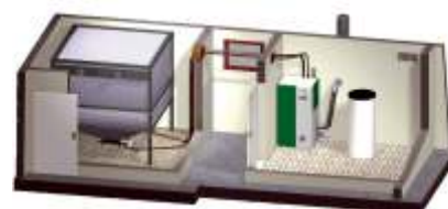
Рис.93 Комбінація з вакуумної системи подачі палива і мішкового бункера
