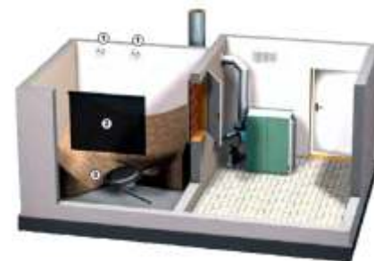
Рис.89 Схема збільшення довжини лінії паливоподачі за допомогою передавального пункту
