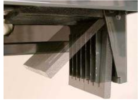
Рис.85 Автоматичне очищення за допомогою рухомої решітки
