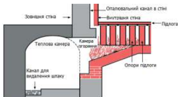
Рис.4 Система опалення «гіпокауст» часів Римської Імперії
