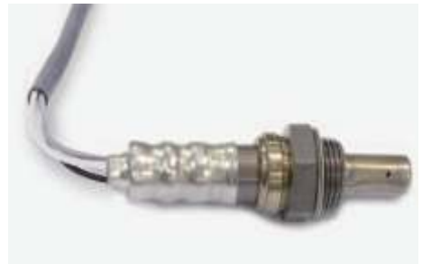
Рис.87 Енергоощадне спалювання завдяки лямбда-зонду
