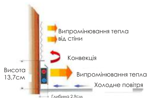
Рис.35 Рух повітря при радіаторному опаленні.
