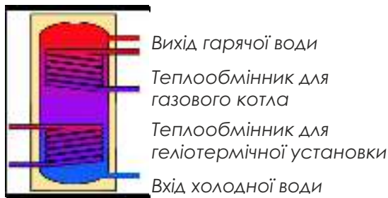
Рис. 184 Бівалентний бойлер непрямого нагріву
